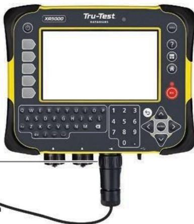
4. Оставьте индикатор заряжаться в течение 8-10 часов перед первым использованием. Во время зарядки индикатора отображается значок "зарядка аккумулятора":
